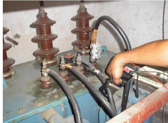
Gambar 4. Foto Pengukuran Arus Pada Trafo
